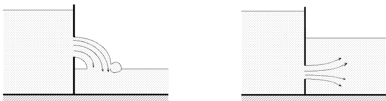
Fig XIII.1.- Orificios según el nivel del agua, aguas abajo
